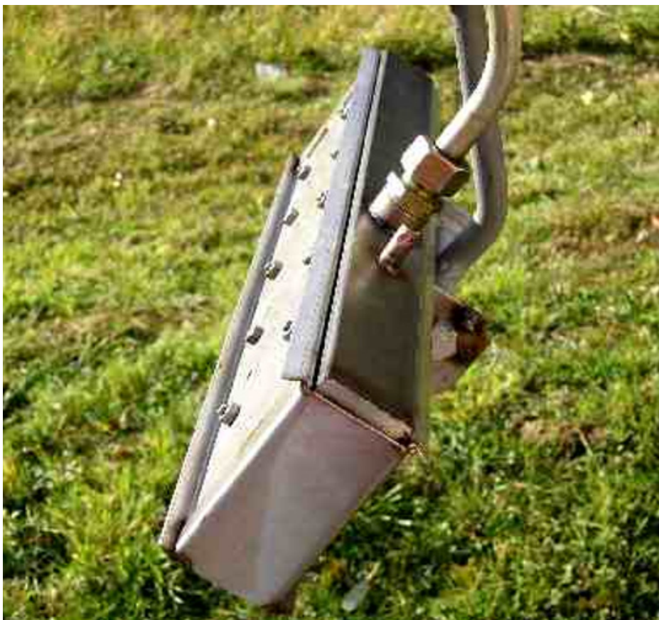
2.4. Ábra: Termikus gyomirtó. Forrás: Magdalena Lacko-Bartosová.
