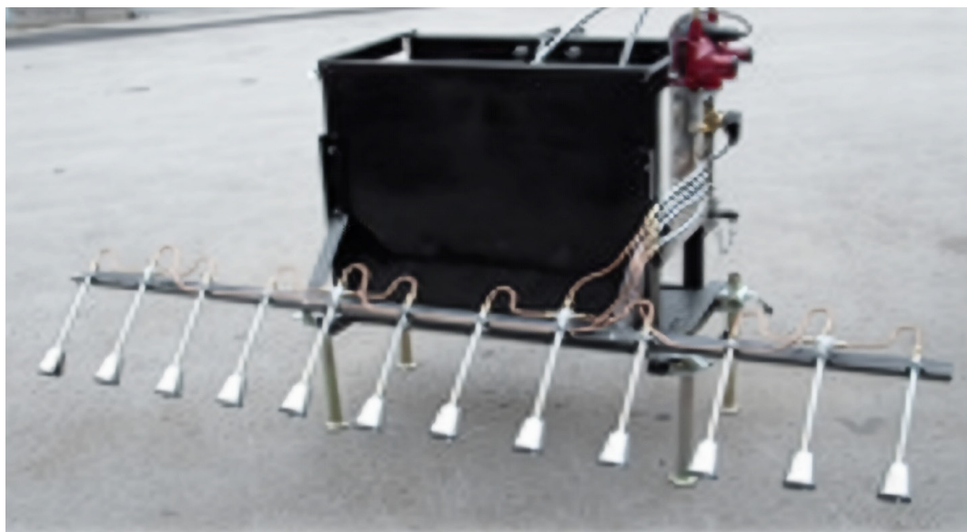
2.6. Ábra: Termikus gyomirtó. Forrás: Magdalena Lacko-Bartosova.
