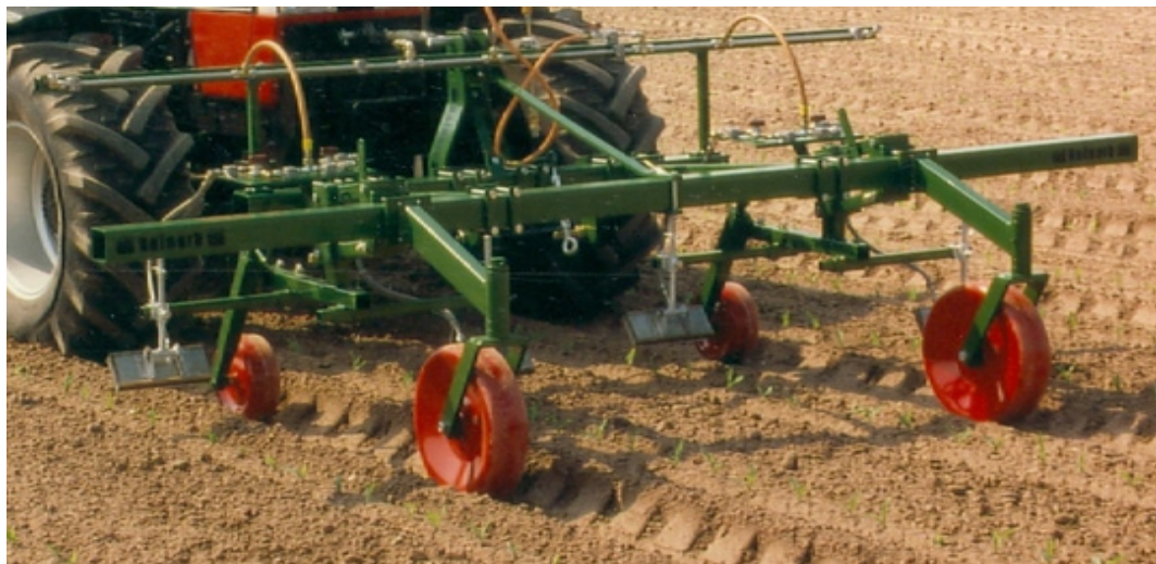
2.5. Ábra: Termikus gyomirtó. Forrás: Magdalena Lacko-Bartosova.
