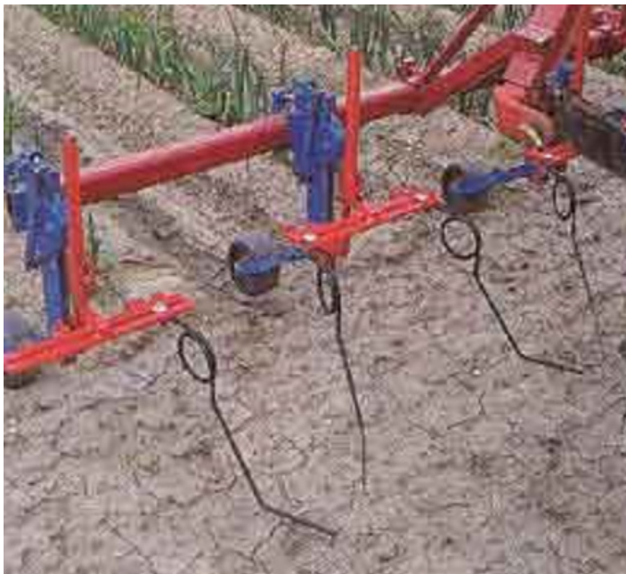
2.3. Ábra: Torziós gyomláló. Forrás: V: Magdalena Lacko-Bartosová.
